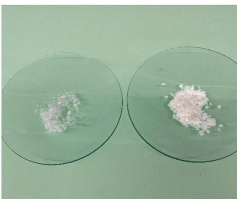
**Figura 9** Mezcla de PP y PET recortado.
